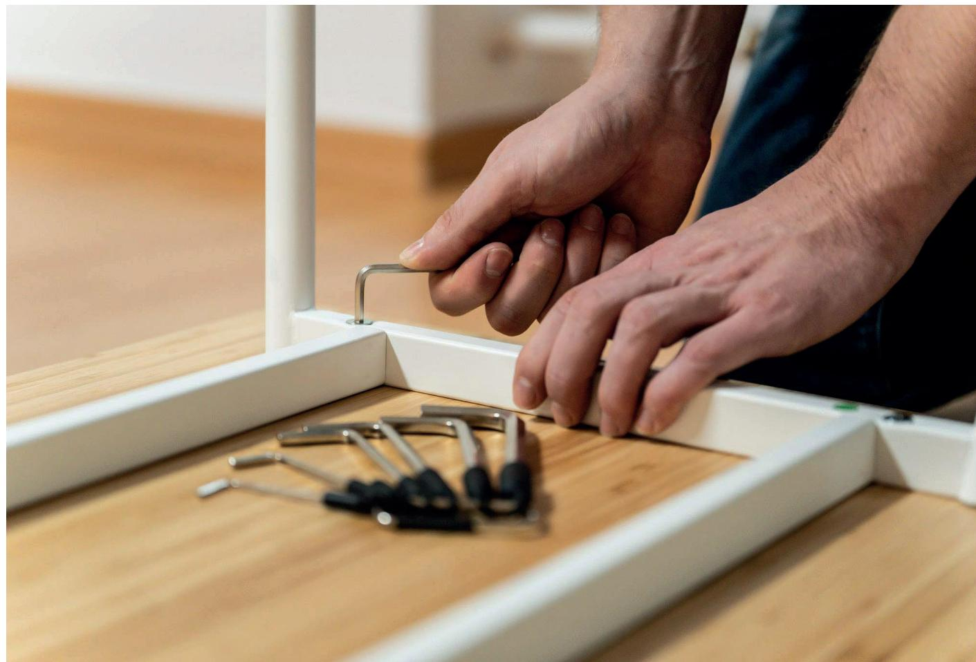
es que una llave desgastada aún "entra", pero ya no transmite el esfuerzo correctamente, incrementando el riesgo de barrido del tornillo y fallas en la instalación.
