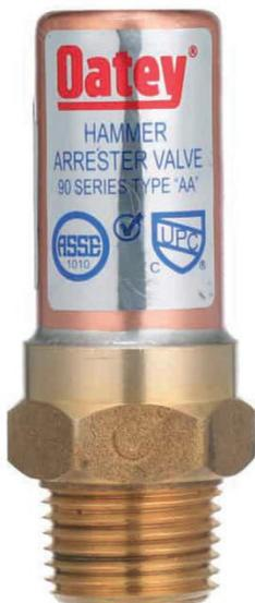
El amortiguador de golpe de ariete está diseñado para absorber y disipar las sobrepresiones generadas por cambios bruscos en el flujo dentro de una tubería y su duración varía según el material, la presión de trabajo y el mantenimiento, alcanzando hasta 10-20 años.
