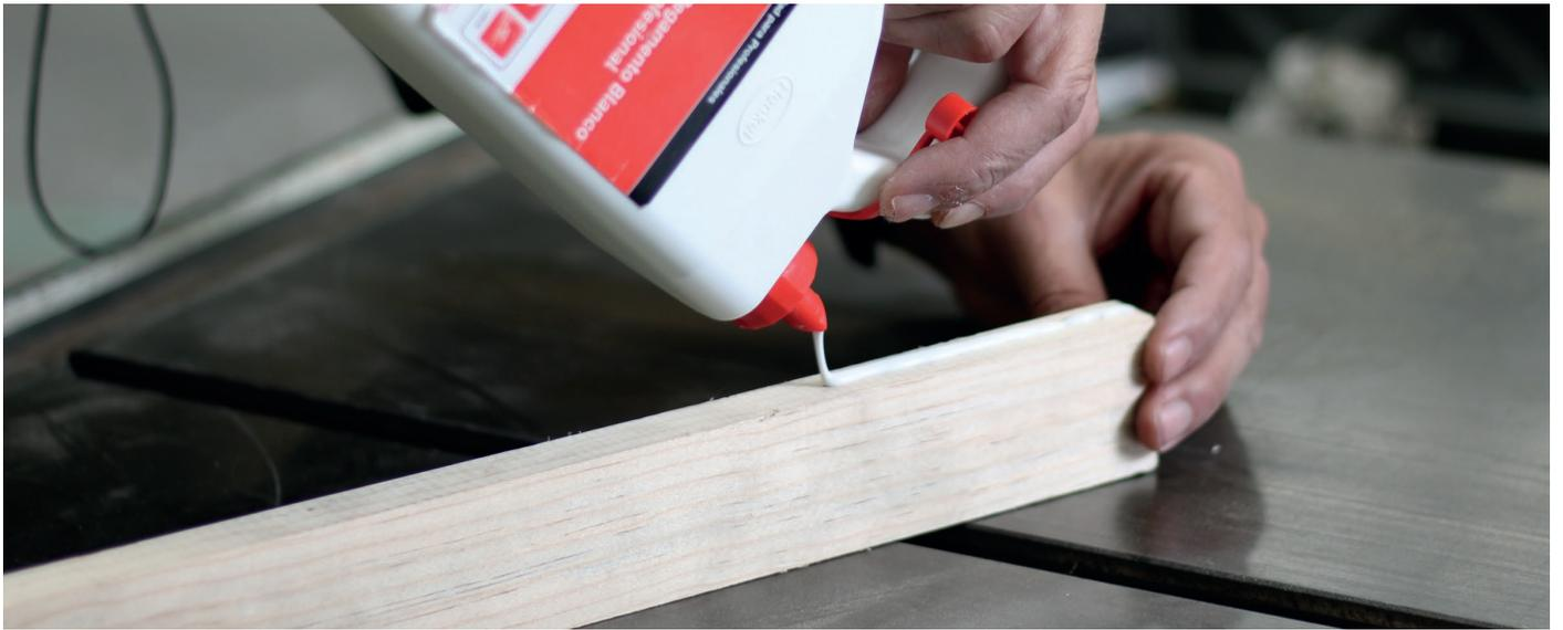
en segundos al contacto con la humedad. En uniones estructurales que requieren alta resistencia mecánica, los epóxicos o poliuretanos son más adecuados, aunque su curado puede tomar varias horas o incluso días. Para aplicaciones en las que se necesita tiempo para ajustar las piezas antes del endurecimiento, los adhesivos de curado lento, como algunos poliuretanos o siliconas, permiten trabajar con mayor margen de maniobra antes de alcanzar su máxima
