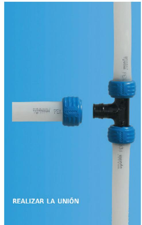
Método de abrazadera (también llamado cincho). En este caso, el primer paso es deslizar la abrazadera o cincho en la tubería, enseguida se colocará la conexión deseada en el extremo de la tubería, se recorrerá la abrazadera sobre la conexión (aproximadamente 3-6 mm de su extremo), para posteriormente prensar la pestaña que sobresale, y fijar la tubería entre la abrazadera y la conexión. Usualmente las abrazaderas están fabricadas en acero común o acero inoxidable.
