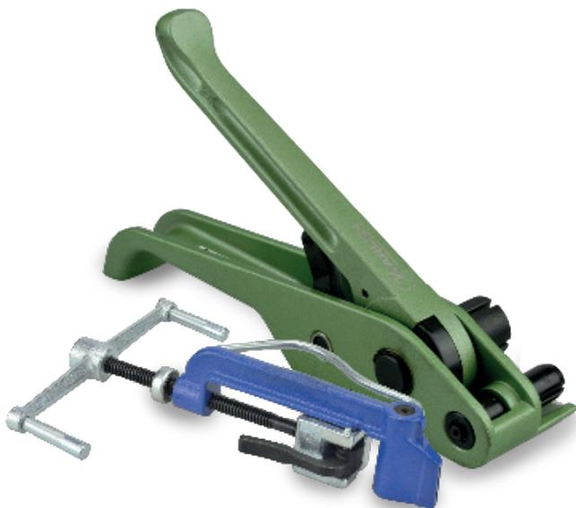
El tensor se utiliza para atar el fleje que rodea un paquete y permite unir los dos extremos del fleje por medio de hebillas de metal que se colocan manualmente. La elección de un tensor de fleje varía en función de la aplicación: principalmente de las cargas a flejar y del tipo de fleje utilizado. En todos los casos, es útil para flejadoras manuales, permiten tensar y cortar rápidamente el fleje alrededor de paquetes y cajas.
