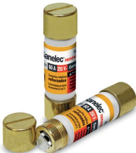
**El fusible** no es más que un elemento conductor encapsulado en un tubo. Este al conectarse a un circuito, recibe corriente del mismo. Se debe calcular el **grosor del elemento conductor** para que, al llegar a determinada intensidad eléctrica, este elemento conductor se funda y no permita el paso de corriente. Si hubiese un golpe de tensión o algo similar, el fusible se quema y no seguirá habiendo corriente en el resto del circuito.
