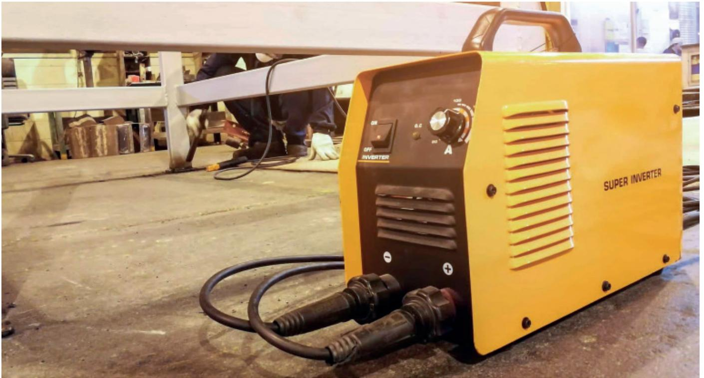
Las máquinas inversoras permiten al operador adaptar el perfil de sus cordones de soldadura a distintas circunstancias y variables, tan ampliamente como sea necesario, mejorando no sólo la apariencia del cordón de soldadura, sino también proporcionando una calidad constante, ya que este avance ayuda a eliminar el exceso de soldadura y el "re-trabajo" que puede ocurrir con las máquinas de tecnología tradicional.
