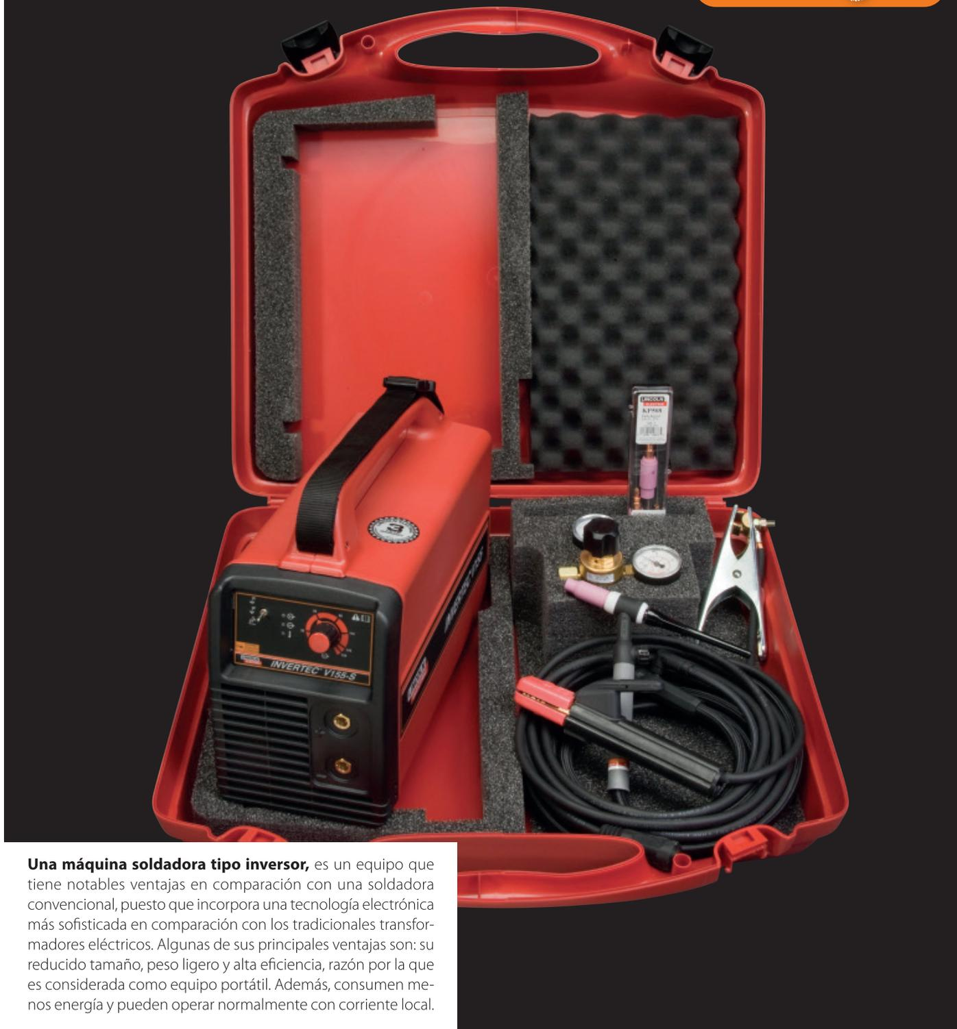
**Una máquina soldadora tipo inversor**, es un equipo que tiene notables ventajas en comparación con una soldadora convencional, puesto que incorpora una tecnología electrónica más sofisticada en comparación con los tradicionales transformadores eléctricos. Algunas de sus principales ventajas son: su reducido tamaño, peso ligero y alta eficiencia, razón por la que es considerada como equipo portátil. Además, consumen menos energía y pueden operar normalmente con corriente local.
